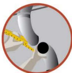
**3** Mise en place d'un second coude avec soudure (ou collage dans le cas du PVC)
