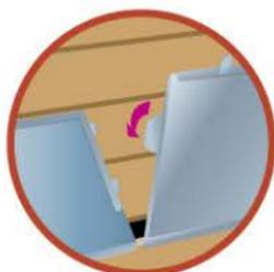
**7** Pose des éléments suivants de la bande de doublis ou bande à ourlet (en longueur de 1 m ou de 2 m)
