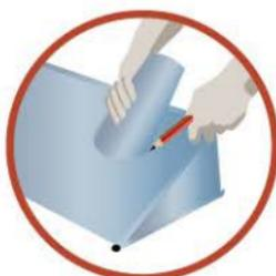
**11** Traçage de l'emplacement de la naissance sur l'envers de la gouttière
