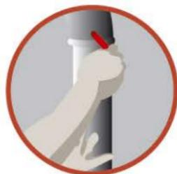
**4** Assemblage du 1<sup>er</sup> tuyau de deux mètres avec sa bague
