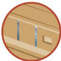
**4** *Vissage de la planche de devant de socle et maintien par ferrures scellées*
