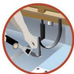
**1** Pose des crochets de basse et haute pente avec soudure des pontets
